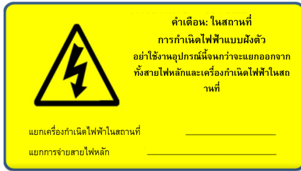
ตัวอย่างของการติดฉลาก (เพิ่มจุดแยกเพิ่มเติมตามความต้องการ)
